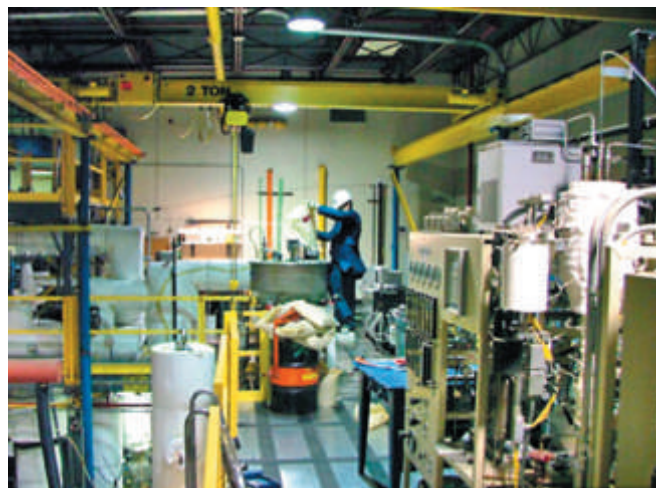
Ilustracija 6 Reaktor s fluidiziranim slojem za pretvorbu biomase u vodik u NREL-u u Goldenu u SAD-u
