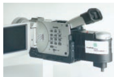
Brennstoffzellen-System mit einer Leistung von 10 W für einen digitalen Camcorder. Eine Entwicklung der Fraunhofer-Initiative Mikro-Brennstoffzelle.
