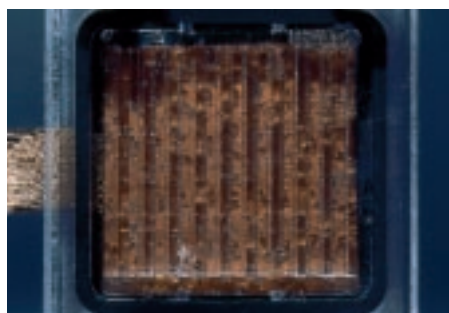
Wasserstoffproduktion in einem Miniatur-Elektrolyseur.
