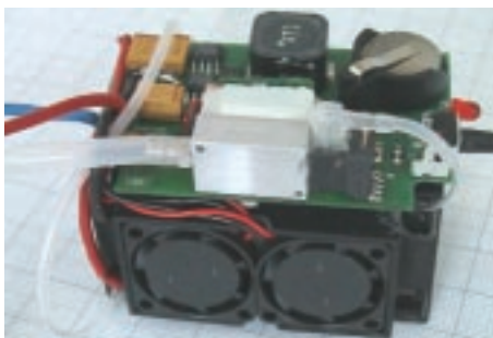
Packaging eines Miniatur-Brennstoffzellen-Systems mit einer Leistung von 10 W inklusive Systemkomponenten.
