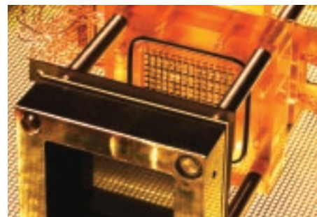
Testzelle zur orts aufgelösten Messung charakteristischer Kenngrößen.
